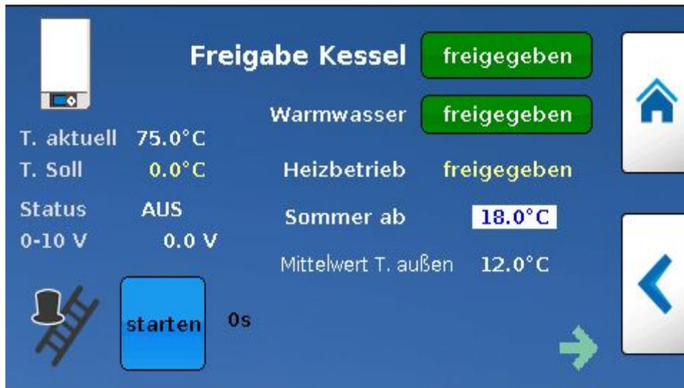
Die Systemregelung bietet mehrere Optionen zur Freigabe des Wärmeerzeugers. Wenn Freigabe Kessel auf [gesperrt] steht, wird eine Nachheizung weder für die Warmwasserbereitung noch für die Raumheizung angefordert.
