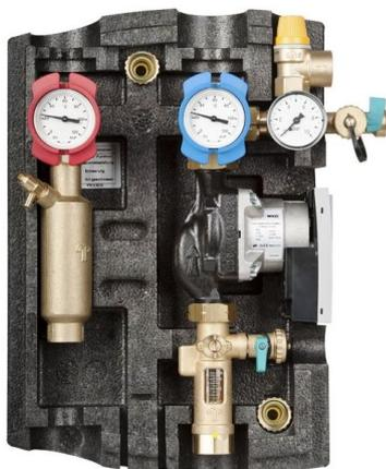
Der Druck im Solarkreis ist bei den meisten Anlagen richtig eingestellt, wenn er zwischen 2 und 3 bar liegt. Die Anzeige dazu liefert das Manometer auf der rechten Seite der Solarstation, unter dem Sicherheitsventil.
