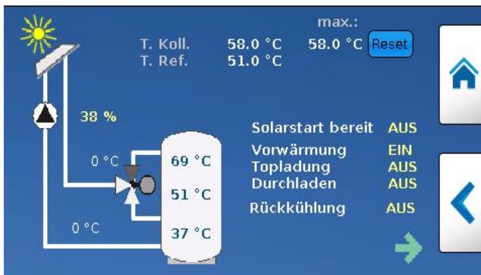
Dieser Bildschirm enthält Detailinformationen zum aktuellen Betriebszustand des Solarkreises. Außerdem wird angezeigt, welche maximale Temperatur der Kollektor seit dem letzten Reset dieses Wertes erreicht hat. Wenn hier immer wieder über 130°C erreicht werden, sollte mit einem Fachkundigen Rücksprache gehalten werden, wie sich das vermeiden lässt.
