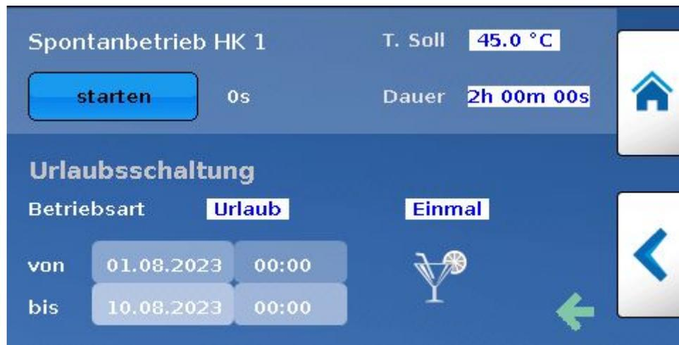
Für den Heizkreis 1 kann für die eingestellte Dauer der Betrieb mit der hier vorgegebenen Vorlauftemperatur ausgelöst werden. Falls der Speicher diese Temperatur nicht hergibt, wird dafür *keine* Nachheizung ausgelöst.
